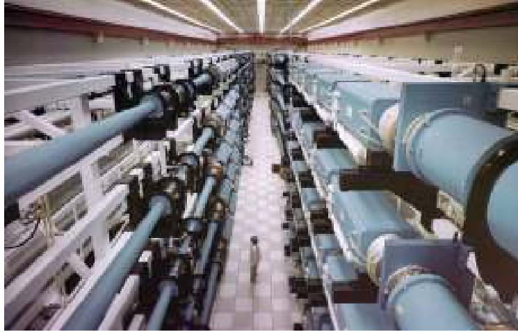
Füzyon Sağlanacak Döteryum + Trityum Hedefi'ne, On Demetlik Bir Lazer Bombardımanı Tesisatı İle, Çok Süratli Şekilde, Büyük Enerji Yığılma Teknikli bir Füzyon Reaktörü (Lawrence Livermore National Laboratory, ABD)
