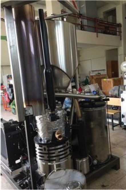
Şekil 1. Deneysel çalışmalarda kullanılan aşağı beslemeli gazlaştırma reaktörü ve sentez gazından elektrik üretilen motora ait görüntü
